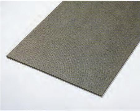
【音シート】VPシリーズは高密度の防音マットです。グレードは2種類。標準タイプの「比重 2.6」と高性能タイプの「比重 3.3」をご用意。特殊アスファルトの制振効果に高比重による遮音効果も加わり、より高い性能を発揮します。
