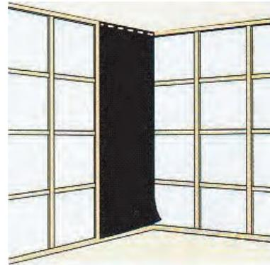
3. 100～150mm ピッチで釘・ステーブルで周囲を固定します。
